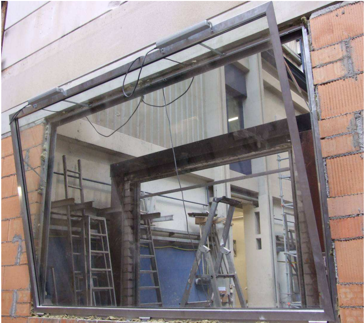
Bild 1: Probekörper vor der Prüfung von der feuerzugewandten Seite
