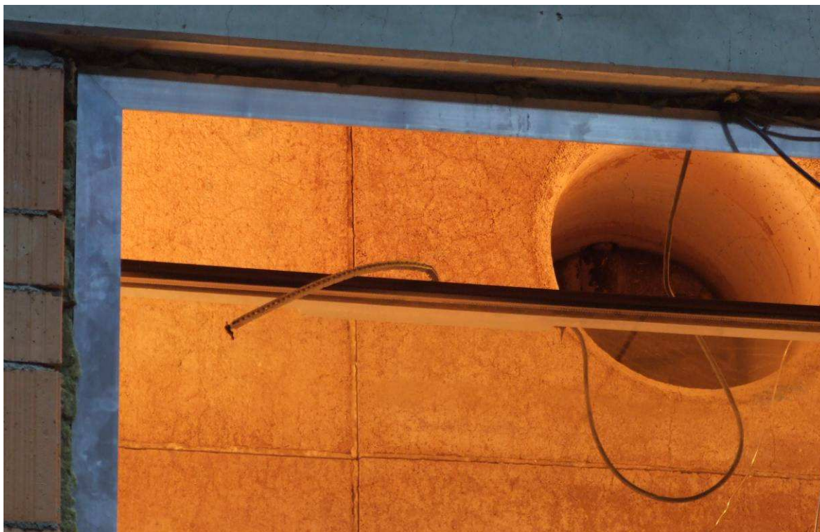
Bild 3: Flügel ist geöffnet, beide Ketten lösen sich aus dem oberen Zargenprofil in der 6. Prüfminute
