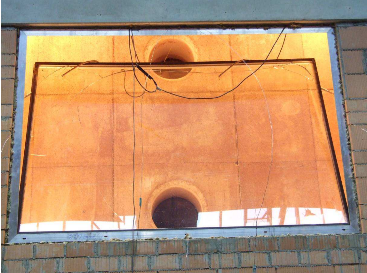
Bild 5: Probekörper in der 22. Prüfminute
