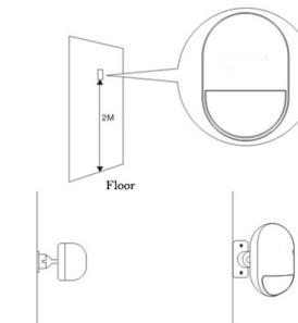
Dupa montarea detectorului in suport si fixarea acestuia pe perete, ajustati pozitia senzorului astfel incat directia de deplasare a persoanelor sa fie cuprinsa intr-un unghi de 90 de grade. Detectorul este sensibil la miscarile pe verticala si mai putin sensibil la miscarile pe orizontala.
