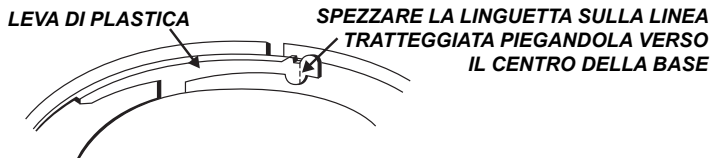
Figura 3a: Attivazione della funzione anti manomissione
